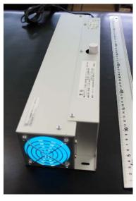
定格 AC100V50/60Hz 18W 6畳間を3-5時間で滅菌 GL8W--紫外線出力 2.5W 紫外線照射強度  $27\mu W/Cm^2$  電源コード 中間スイッチ付き FAN  $0.2 m^3/m$  in
